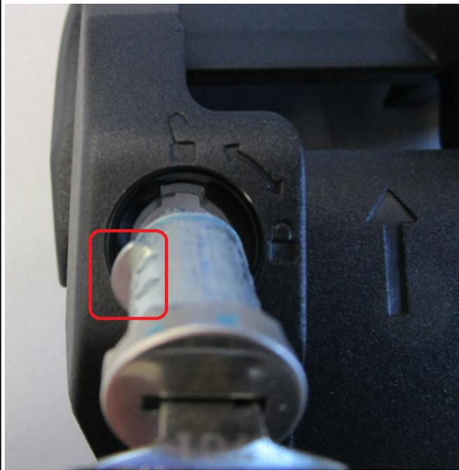
Nach dem Einsetzen das Schloss noch unter etwas Druck nach **RECHTS** drehen. Hierdurch wird sichergestellt, dass der Sicherungssplint wieder rauspringt und das Schloss in der Abdeckkappe arretiert ist.
